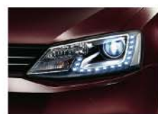
Биксеноновые фары со светодиодными огнями
